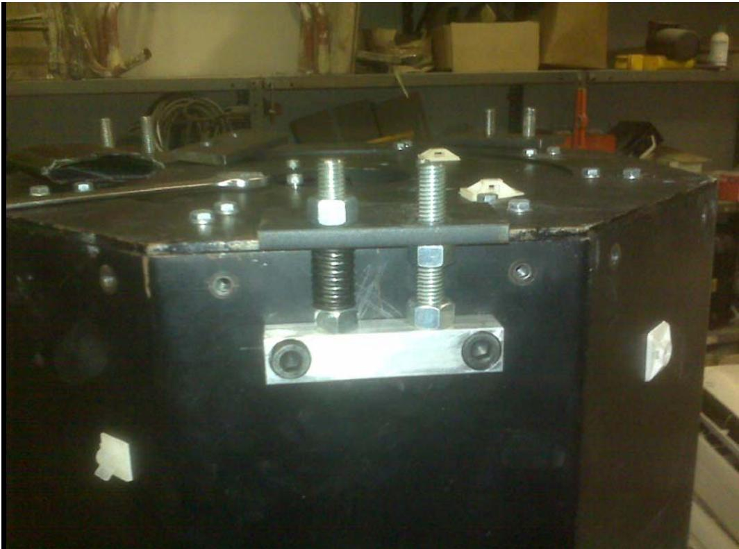
Sulla cella poi, sono anche state aggiunte tre viti di blocco dello specchio primario, per evitare possibili micro spostamenti dello specchio stesso, e sempre per avere maggiore assicurazione del mantenimento del primario nella posizione corretta, sono stati rifatti i supporti laterali dello specchio, ora molto più robusti e facilmente regolabili rispetto a quelli esistenti.
